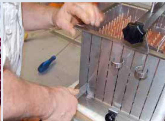
Mit dem Schaschlikaufspießgerät Spikomax sind im Handumdrehen 108 Spieße in 20 Minuten hergestellt.
