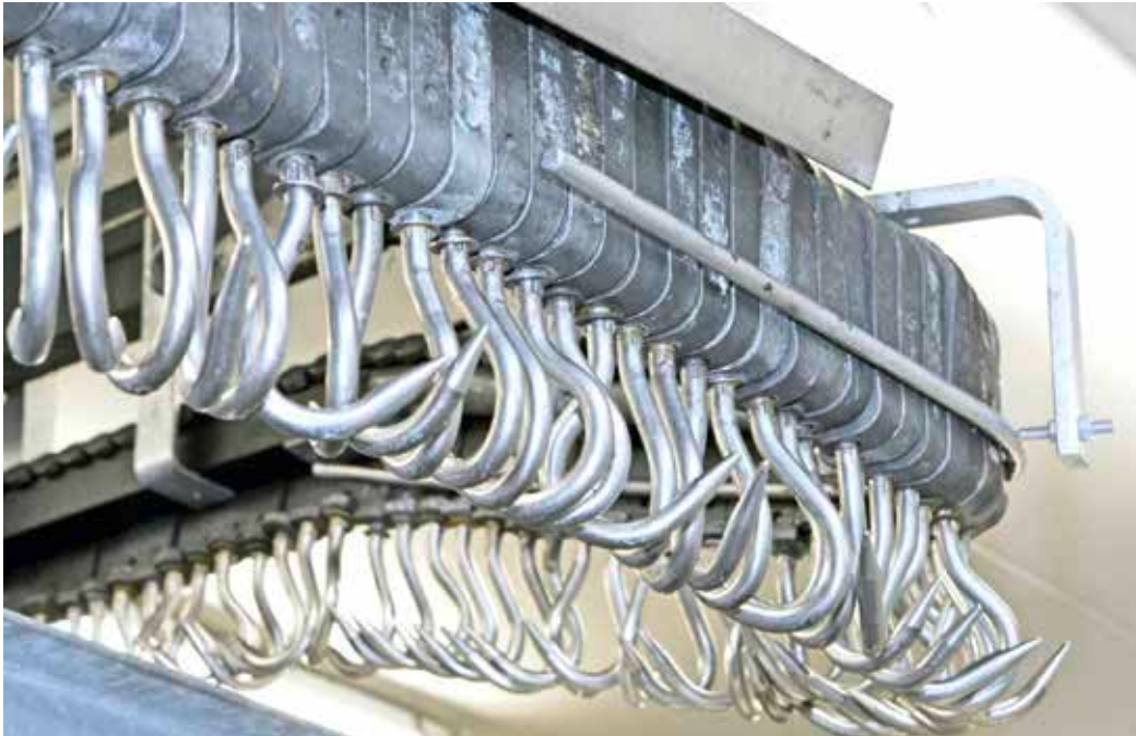
Seitliche Führungsschienen als Absturzssicherung/ Lateral guiding track functioning as protection against derailing hooks
