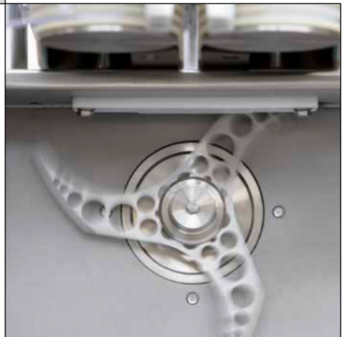
Zerkleinerer mit integriertem Vakuumprozess, vierstufigem modularen Schneidsatz und Regelung für die Produkttemperatur. Stufenlos einstellbares Vakuumniveau, Produktfeinheit und -temperatur konstant geregelt.
