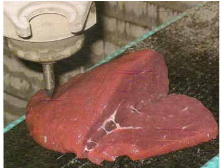
Abb. 1: Experimentelles Schneiden von Rindfleisch mit dem Wasserstrahl Image 1: Experimental cutting of beef by means of a water jet
