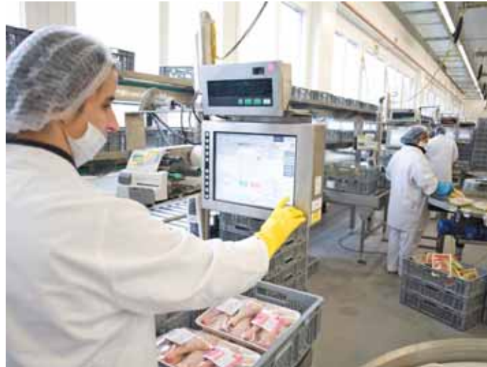
Die verpackten Waren werden entsprechend dem Auftrag kommissioniert. Der Steel-IPC hilft den Beschäftigten dabei. / The packed goods are commissioned according to the order. Steel-IPC from noax helps the employees.
