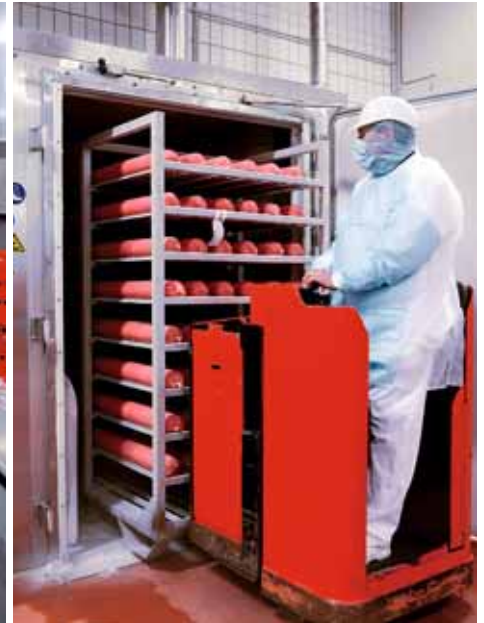
li: CO 2 , N 2 und O 2 dienen in verschiedenen produktspezifischen Mischungen zur Verpackung unter Schutzatmosphäre (Modified Atmosphere Packaging, MAP). re: Die Froster werden jeweils chargenweise im Batch-Verfahren befüllt.
