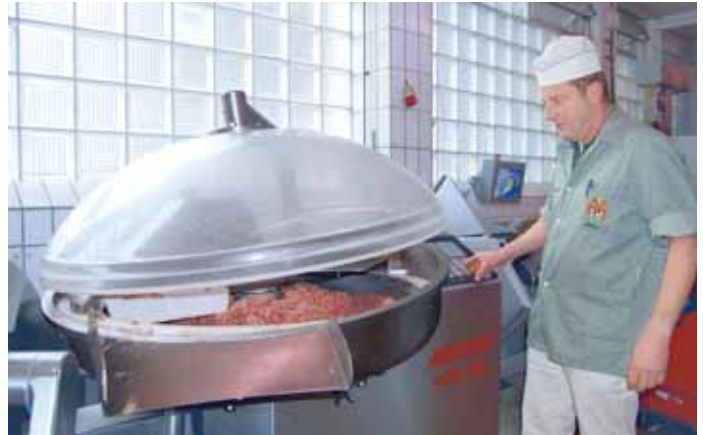
Der 120-Liter-Vakuums-Cutter arbeitet wirtschaftlich./ The vacuum cutter 120l works economically.
