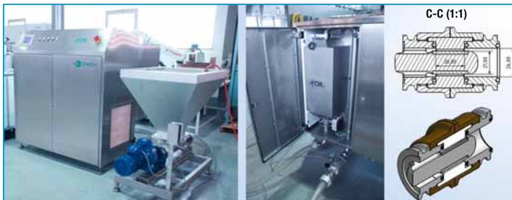
Abbildung 9: Industrielle Anlage zur Entkeimung mittels gepulster elektrischer Felder, Anlagenleistung: 30 kW, Behandlungskapazität: 2.000 l/ h. / Image 9: Industrial decontamination unit on the basis of pulsed electric fields, unit performance: 30kW, treatment capacity: 2,000/h.
