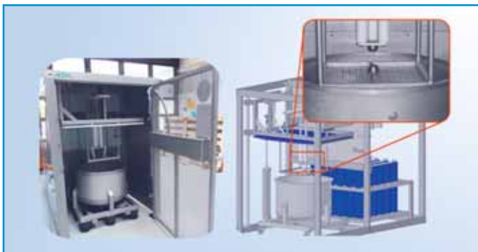
Abbildung 6: Funktionsmuster zur Erzeugung elektrohydraulischer Stoßwellen, bestehend aus Energieversorgung, Behandlungswanne und Entladestrecke. Ausschnitt: Vergrößerung der Elektroden. / Image 6: Evaluation model of the production of electro-hydraulic shock waves-consisting of an energy supply, a treatment chamber and discharge path. Section: Enlarged electrodes.
