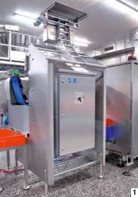
1) Bestens geschützt und von hinten zu öffnen: Hygienic Design-Gehäuse von Rittal in der CWP Neptune-Anlage bei WestfalenLand 2) Bergauf geht auch: CWP Neptune mit schräg gestelltem Förder- bzw. Transportband 3) Anlage im Reinigungszustand – ohne Frontverkleidung und Transportgurt
