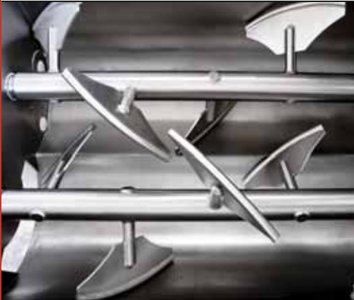
IM - Serie mit ineinandergreifenden Paddeln - Aktion über die gesamte Länge vom Mischtrug deshalb schnelles Mischen - Wellen auf unterschiedlichen oder gleichen Höhen
