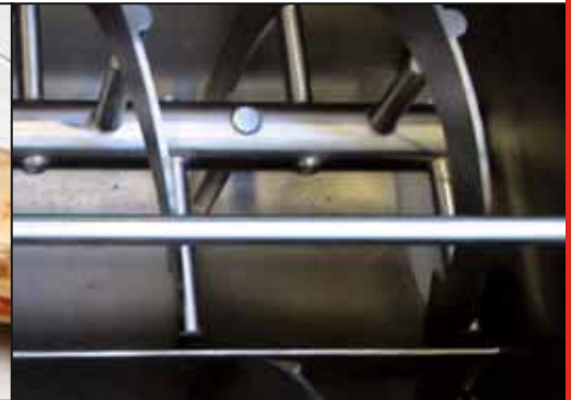
IM - Serie mit ineinandergreifenden Paddeln - Aktion über die gesamte Länge vom Mischtrug deshalb schnelles Mischen - Wellen auf unterschiedlichen oder gleichen Höhen
