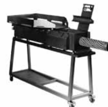
Netzeinziehgeräte RSM Rationelles befüllen in Netze oder Därme. Ideal für Rollbraten und Schinken. Mit dem Folienvorsatzgerät kann in Netze essbare Folie verarbeitet werden. Passend dazu unser Netzraffgerät.
