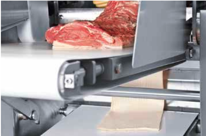
Per Abführband lässt sich das entschwartete Fleischstück direkt zum nächsten Arbeitsplatz weitertransportieren. Der sauber entfernte Rückenspeck wird nach unten abgeführt.
