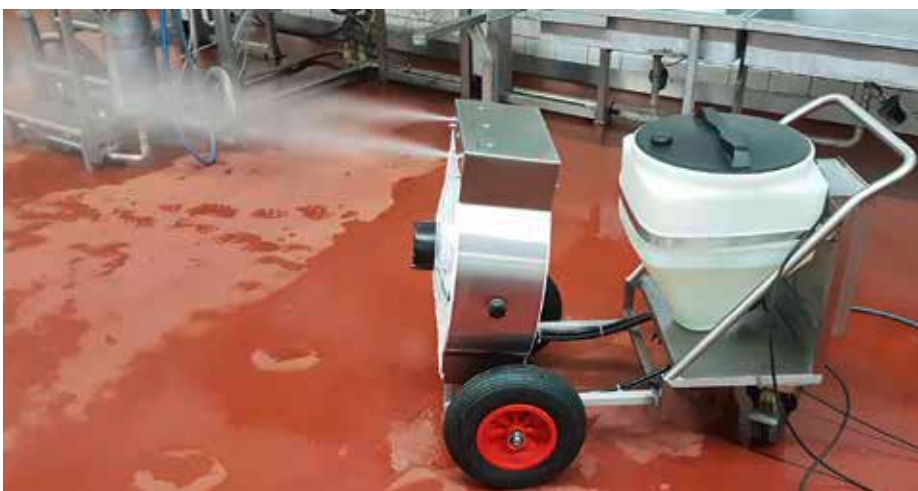
▲ Gängige Methode zur Einkeimung ist in vielen Betrieben ein Desinfektions-Sprühwagen. / In many cases, a disinfection sprayer is the common method of sterilisation.
