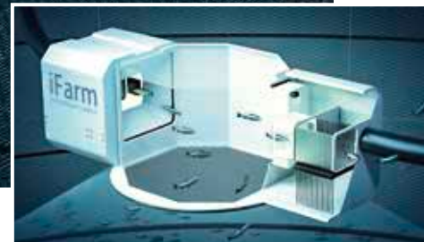
iFarm is based on photo recognition of the fish. / iFarm basiert auf einer fotografischen Erkennung der Fische.
