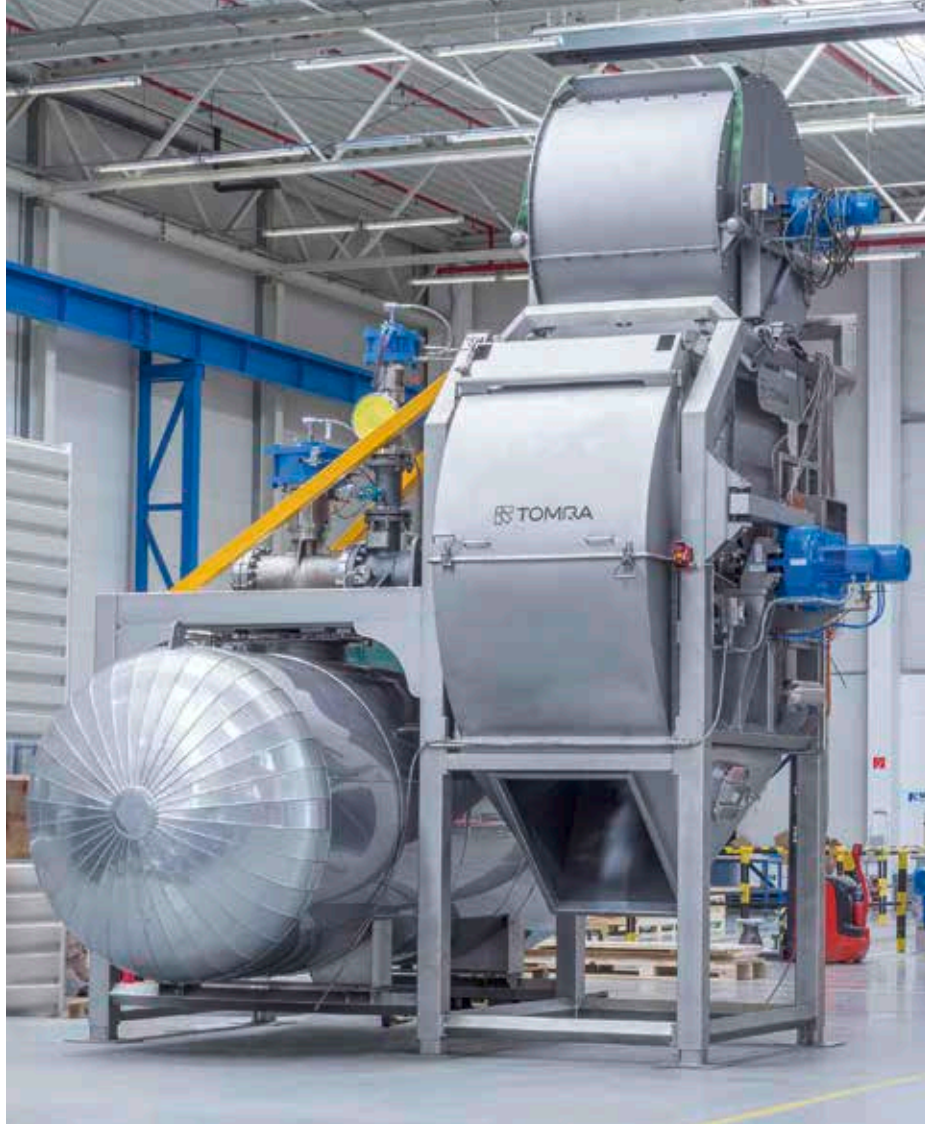
Der weltgrößte Eco-Dampfschäler von Tomra ist mehr als 8 m hoch und kann 650 kg Kartoffeln in weniger als sieben Sekunden schälen. /
