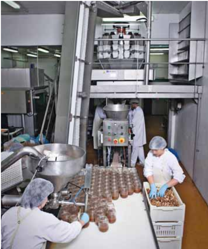
Die Mehrkopfwaage füllt das Fleisch direkt in Glasbehälter ab. / The multihead weighers feed the prepared meat directly into the glasses.
