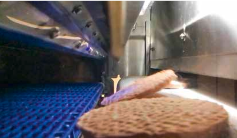
Das Röntgeninspektionssystem X39 erkennt kleinste Fremdkörper und optische Mängel. Der integrierte Kontroll-Laser schleust einzelne fehlerhafte Patties automatisch aus. / The X39 X-ray inspection system detects slightest foreign bodies and visual defects. Thanks to the integrated control laser it automatically ejects individual defective patties.
