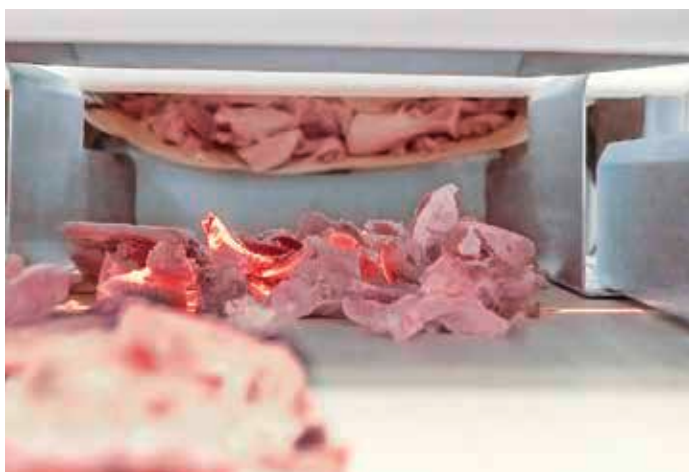
Bis zu 30 t Fleisch in verschiedenen Formen und Größen kann der Tomra Q-Vision pro Stunde kontrollieren. / The Tomra Q-Vision is able to control 30 t of meat in various shapes and sizes per hour.
