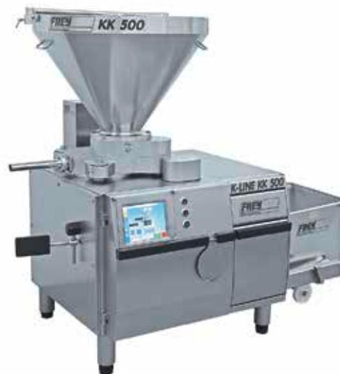
продукта по отношению к внешнему виду заполнения и гигиены. Обычные обогревание и контаминация во время простоев уменьшаются. Мясорубная система устанавливается просто вместо передачи свертывания. Могут применяться 4- или 5-частные режущие диски величиной в 98 мм. С помощью отрезного диска можно сепарировать сухожилия, хрящи и кости.
