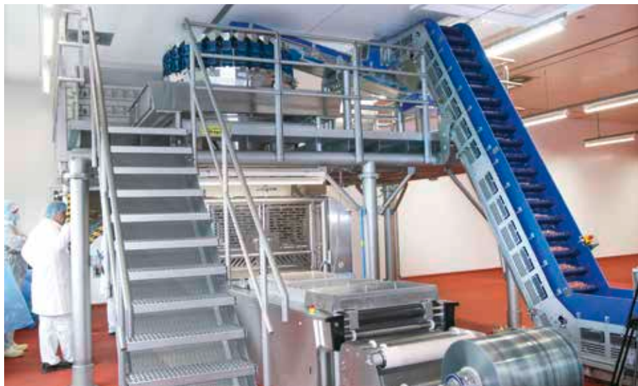
Die Mehrkopfwaage ist für den Einsatz mit extremen Hygieneanforderungen ausgelegt. / The multi-head weighing machine has been developed for use in areas with extreme hygiene requirements.
