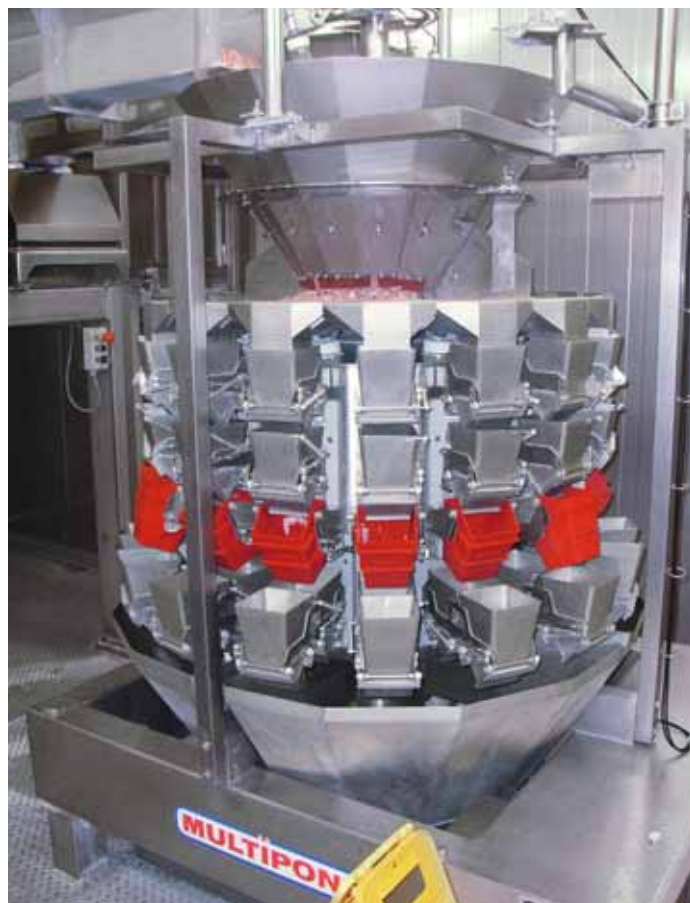
16-Kopf-Speicherwaage vom Typ MP 1612-FFC-S5 mit einer zweifach-Produkttrennung/ 16-head memory weigher, an MP 1612-FFC-S5 with two-way product separation
