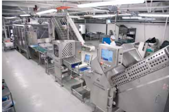
Der PolySlicer 3000 wird automatisch beschickt und kann bis zu vier Stangen Salami gleichzeitig schneiden. / PolySlicer 3000 automatically loads and slices up to 4 logs of high quality salami at a time.
