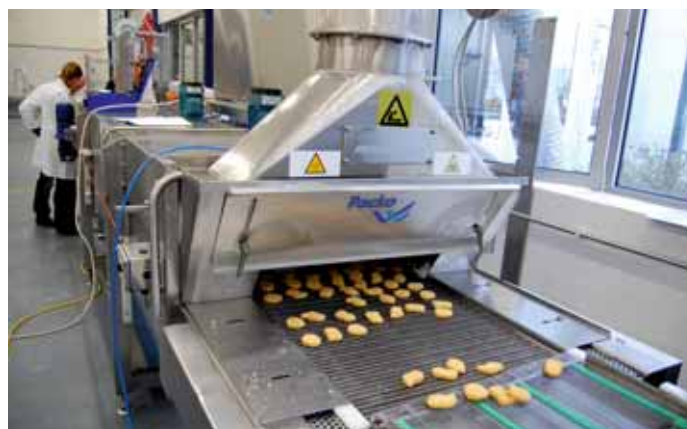
Die Snacks werden bei -30^{\circ}\text{C} schockgefrostet. The snacks are shock frosted at -30^{\circ}\text{C} .
