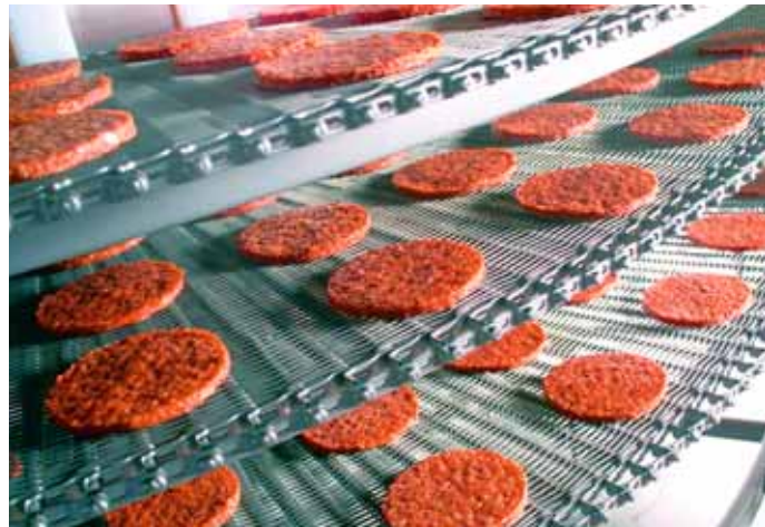
Schnelles Frostern verhindert Gewichtsverluste. Immediate freezing minimizes weight loss.
