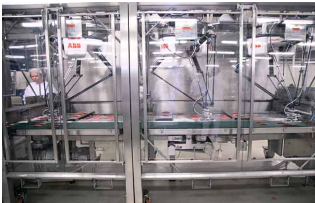
Die drei Greifer des IPL Roboters legen die Aufschnittgruppen schnell, schonend und exakt im Thermoformer. IPL Robot's 3 heads quickly, gently and precisely place sliced groups into the thermoformer at, typically, 180 picks/min.
