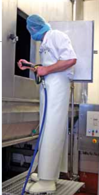
Die große Inspektionstüre erleichtert das Reinigen des Siloinnenraums./ The large inspection hatch makes it easy to clean the inside of the silo.
