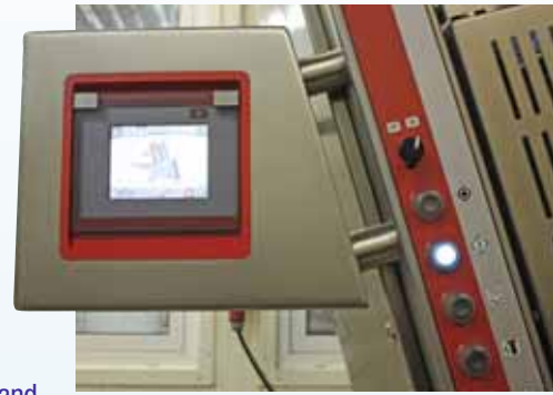
Touch-screen mit intuitiver Bedienung./ Settings can be made intuitively via the touch screen.
