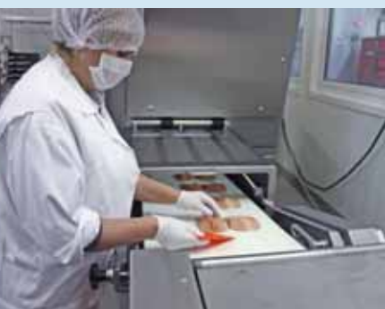
Der Slicer legt die Produkte gefächert ab./ The products are fanned in portions.
