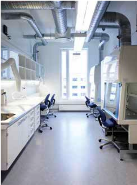
Auch in der Fleisch- und Lebensmittelindustrie, z. B. in den Laboren, kommen antistatische und/oder ableitfähige Böden zum Einsatz, bei denen es sich um ausgeklügelte Schichtsysteme handelt.
