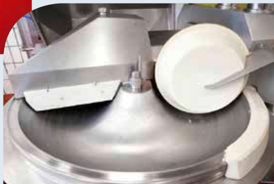
Der Auswerfer des Kutters sorgt durch seine spezielle Konstruktion für eine schnelle und restlose Entleerung der fertigen Produkte.
