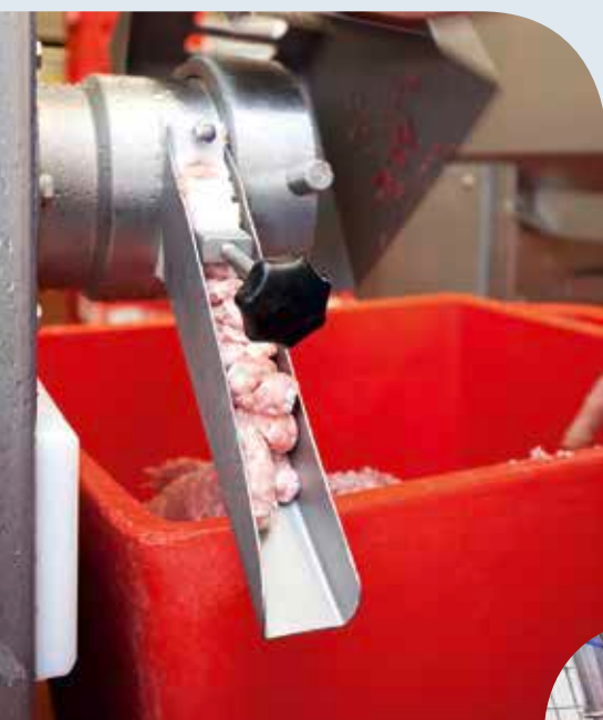
Durch die seitliche Abführung der Hartanteile am Winkelwolf erhöht sich die Qualität des gewolften Fleisches.
