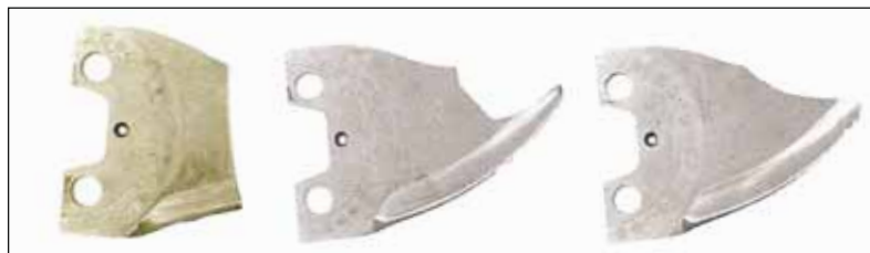
1: Zerstörte Messer von Hochgeschwindigkeitskuttern 1: Destroyed blades of high-speed cutters
