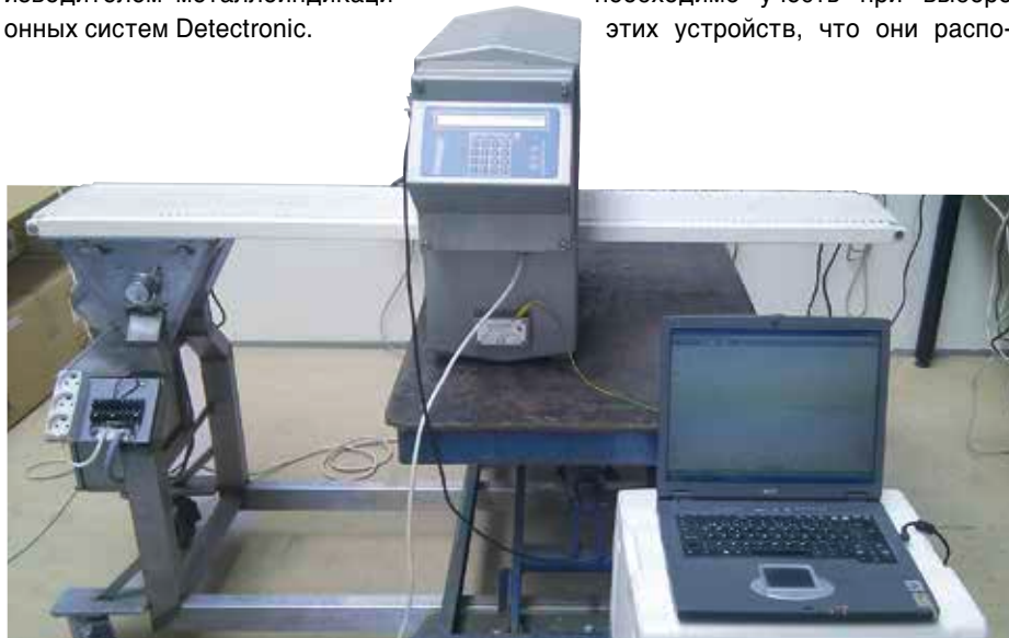
▲ Металлический детектор фирмы Detectronic и испытательная станция, с которой контролировалась познаваемость металлодетектируемых пластмасс.
