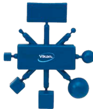
▲ Примерный испытательный образец для металлодетектируемых пластмасс (Vikan), как он предоставляется в некоторых случаях для приборов из металлодетектируемой пластмассы.
