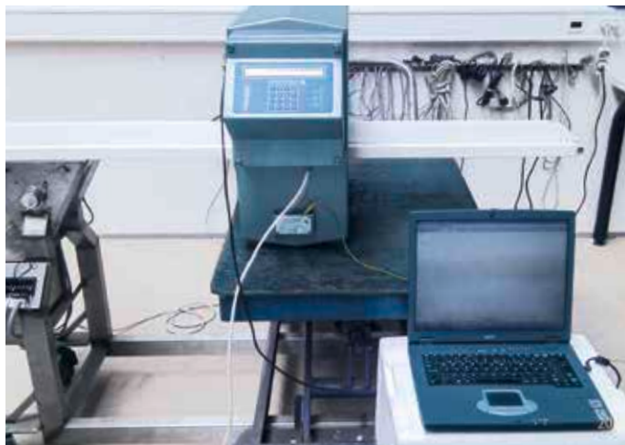
Der Metalldetektor von Detectronic (Modell-Nr. 606-250), mit dem die Erkennbarkeit von metalldetektierbaren Kunststoffen überprüft wurde, die in der Herstellung von Arbeits- und Reinigungsgeräten für die Lebensmittelindustrie verwendet werden. / The Detectronic metal detector (Model No. 606-250) used to assess the detectability of metal detectable plastics used in the manufacture of equipment for the food industry.
