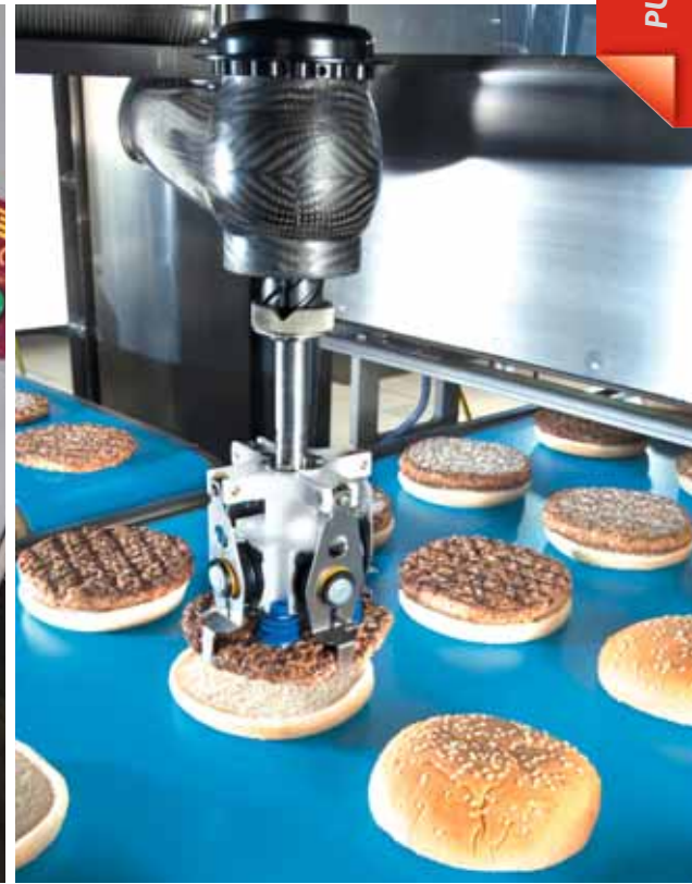
Das Zuführsystem vereinzelt die gefrorenen Brätlinge und fährt sie dem Picker zu. / The feeding system precisely regulates product spacing using step motors in the roller transport system.
