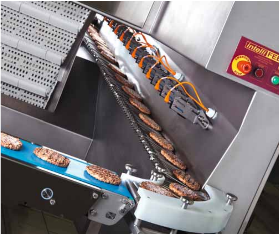
Das Zuführsystem vereinzelt die gefrorenen Brätlinge und fährt sie dem Picker zu. / The feeding system precisely regulates product spacing using step motors in the roller transport system.
