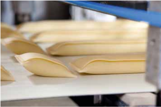
Beim Schneiden bewegt sich das Messer mit dem Band./ During cutting the blade moves at the same speed as the belt.
