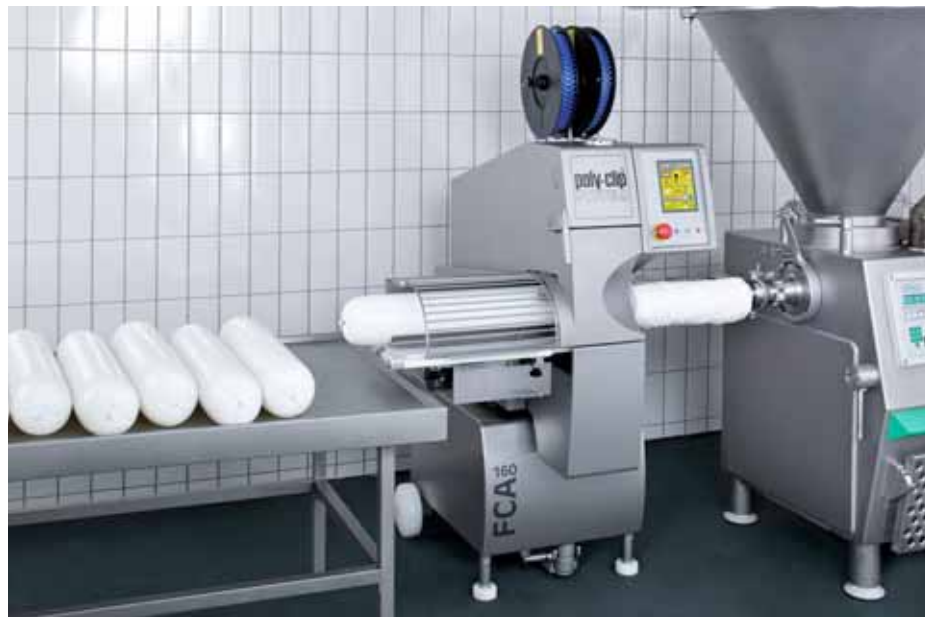
Am FCA 160 lassen sich Stangenwürste in hoher Taktzahl verarbeiten. / On the FCA 160 large calibre sausages can be clipped safely and quickly.
