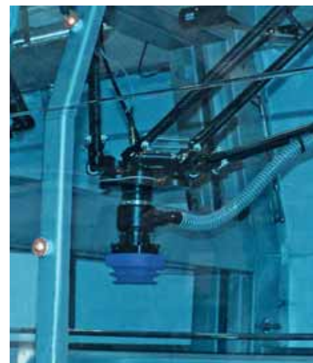
Der Vakuumgreifer ermöglicht hohe Durchsätze./ The vacuum gripper supports high throughput.
