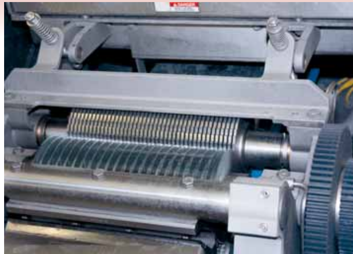
Die Rundmesser der Urschel M6/ The rotating blades of the Urschel M6
