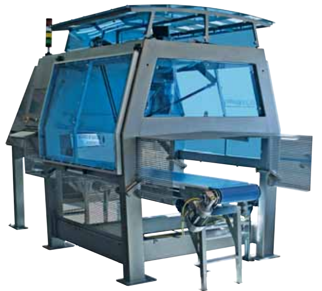
Die verpackten Hähnchen werden angesaugt (links) und anschließend in Kartons verpackt./ The packed chicken are picked up (left) and then packed into boxes.
