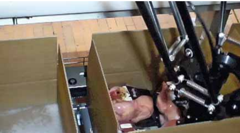
Die verpackten Hähnchen werden angesaugt (links) und anschließend in Kartons verpackt./ The packed chicken are picked up (left) and then packed into boxes.
