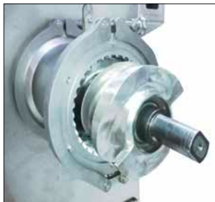
Die Arbeitsschnecke mit Schneckengangmesser und vier Förderpunkten.
