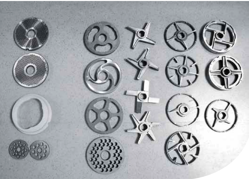
In der Studie wurden Messer in drei-, vier- und fünfflügeligem Design in den unterschiedlichsten Schneidsätzen mit diversen Schräglochscheiben kombiniert und getestet.
