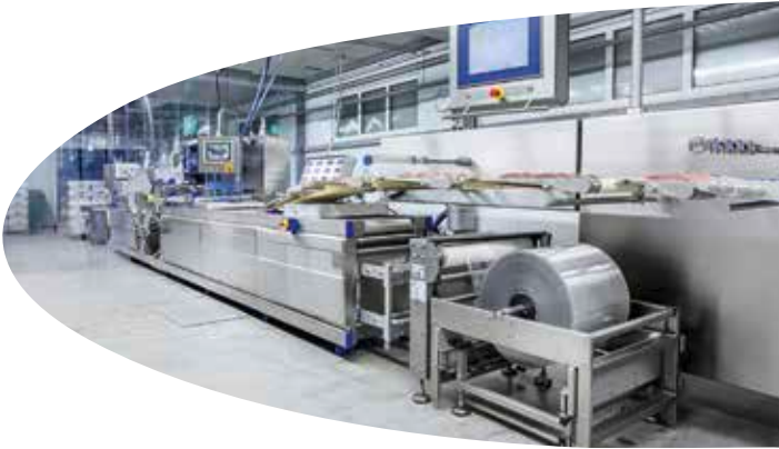
Der Sealpac RE25 Thermoformer gibt bis zu 80 Packs Salami /Min. aus. / The Sealpac RE25 thermoformer achieves outputs up to 80 salami packs/min.
