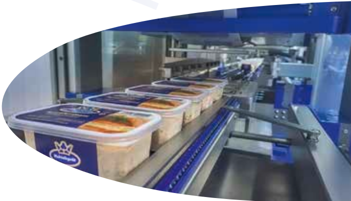
Die Sealpac A5 erzielt je nach Anwendung einen Output von bis zu 40 Trays pro Minute. / The Sealpac A5 traysealer achieves up to 40 trays per minute.
