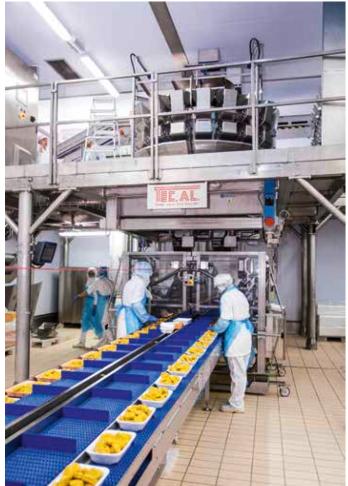
Unterhalb der Mehrkopfwage befindet sich das Verteilsystem für die Abfüllung in die Schalenverpackungen./ The distribution system for filling into the tray packs is underneath the multi-head weigher.
