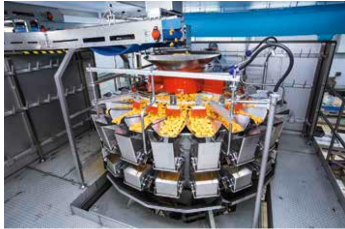
Die Chicken Nuggets gelangen von oben auf die in zwei Sektionen geteilte Mehrkopfwage CCW-R./ The chicken nuggets are supplied from above onto the multi-head weigher CCW-R split into two sections.
