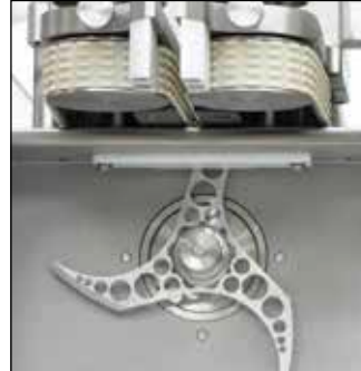
Inotec Zerkleinerer mit vierstufigem modularen Schneidsatz
