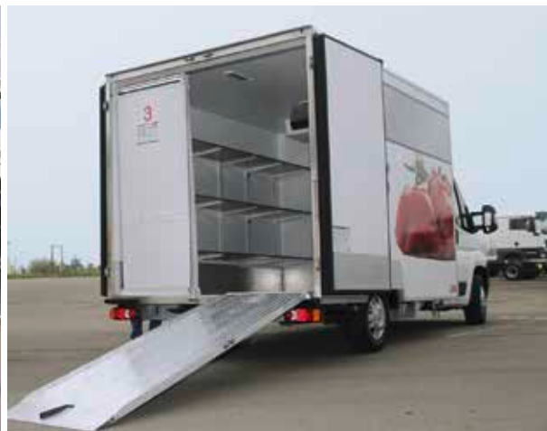
Die Rampe bei Kiesling Fahrzeugbau ist im Inneren verborgen.
