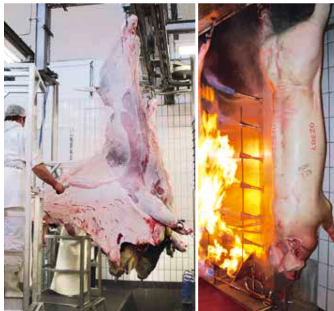
Flämmen und Enthäuten erfolgen heute teilweise oder völlig automatisiert. In modern days, dehiding and unhairing are partially or fully automated processes.
