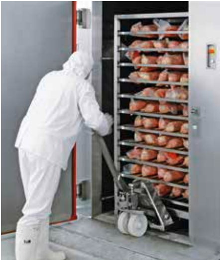
Beschickung von Batchanlagen zum Kochen./ Loading of batch chambers for cooking processes.
