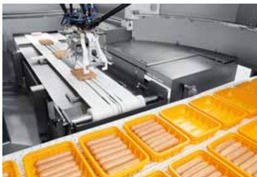
предоставляет оператору центральное управление и мониторинг всех функций с простой логикой управления на основе Windows. Предприятие кроме этого и предлагает решения с переходными устройствами к упаковке, как автоматическое вкладывание сосисок в различные упаковки. В области дозирования у фирмы Handtmann имеется новое решение с прямым подводом к упаковке и автоматизированная линия порционирования фарша с точкой пересечения для вкладывания как в чаши, так и в машины глубокой вытяжки.
