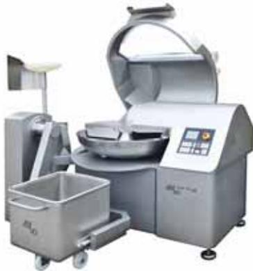
Для изготовления вареной или сырой колбасы подходит куттер фирмы Мадо Supra Vacuum MSM 767 VA со вместимостью чаши в 130 л.. Созревшая куттерная техника в сочетании с новаторским управлением машины здесь обеспечивает воспроизводимые рабочие результаты. Программируемое
