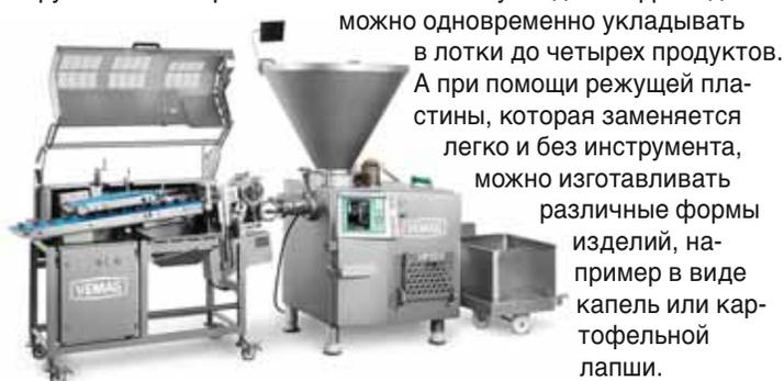
можно одновременно укладывать в лотки до четырех продуктов. А при помощи режущей пластины, которая заменяется легко и без инструмента, можно изготавливать различные формы изделий, например в виде капель или картофельной лапши.
