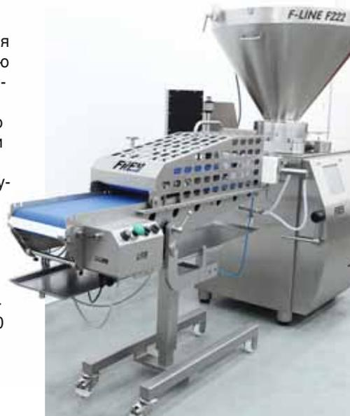
консистенцией и благодаря своему внешнему виду производят впечатлительную продукцию, изготовленную вручную. Высокую гибкость демонстрирует выбор объема порций, диаметра формы и толщины. Диаметр изделий представлен в диапазоне от прибл. 30-200 мм. Высота изделия варьируется от 5-55 мм. Мощность порционирования линии составляет макс. 150 порций/мин. Дополнительно в наличии есть накатный ролик, при помощи которого можно формировать структуру и штамповать рисунок на поверхности изделий.
