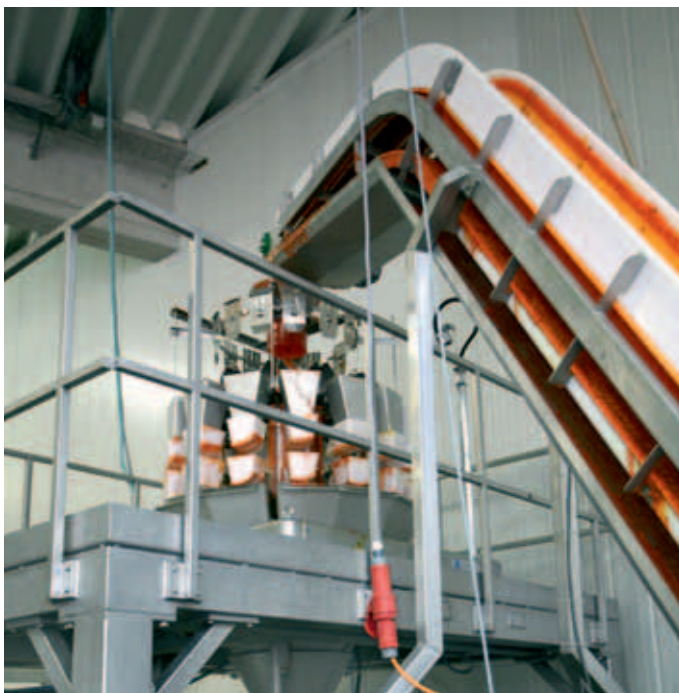
Ein Steigförderer führt das marinierte Fleisch der Waage zu./ An ascending conveyor takes the marinated meat to the scales.
