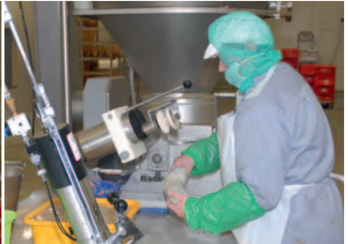
Mit dem ClipStar lassen sich u. a. Wurstketten herstellen und Därme unterschiedlichster Art verarbeiten./ The ClipStar allows the production of sausage chains and is suitable for all types of sausage casings.
