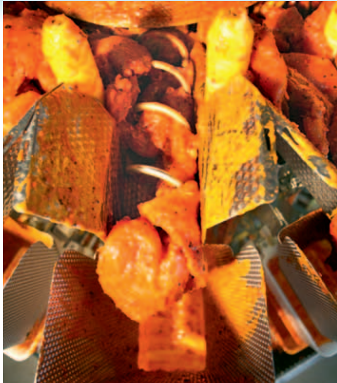
Die innovativen Spiralförderer sorgen für einen reibungslosen Produktfluss./ The innovative spiral conveyors ensure a smooth product flow.
