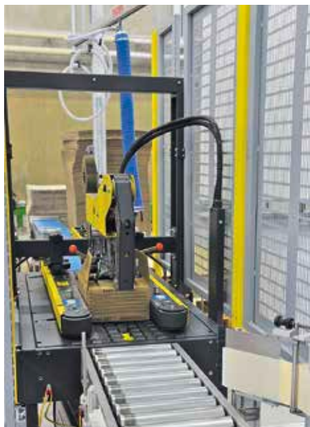
Bild links: An der Wägestation wird das exakte Gewicht des Kartons ermittelt, um festzustellen, ob er vollständig bepackt ist. left: At the weighing station, the exact weight of the carton is determined to ensure it has been filled completely.
