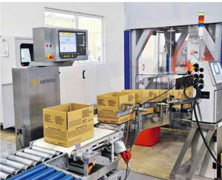
Bild links: An der Wägestation wird das exakte Gewicht des Kartons ermittelt, um festzustellen, ob er vollständig bepackt ist. left: At the weighing station, the exact weight of the carton is determined to ensure it has been filled completely.
