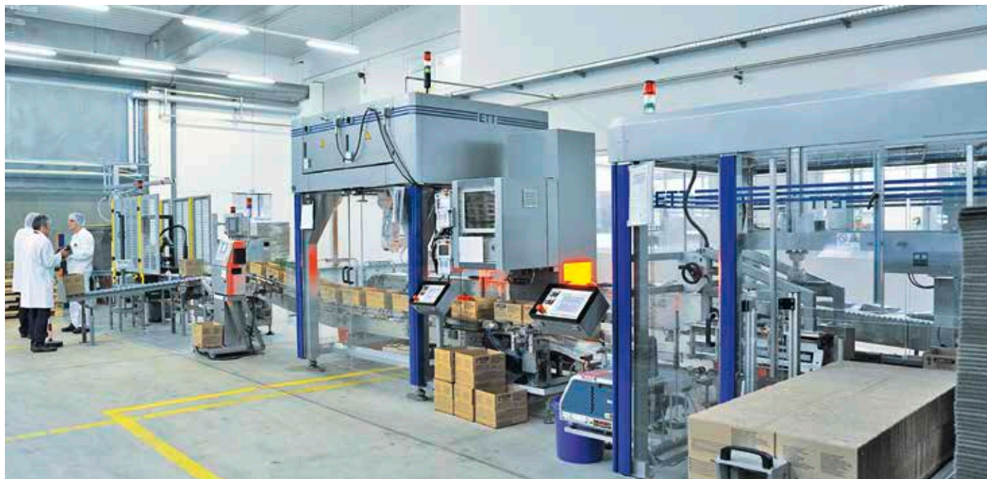
Die Endverpackungslinie von ETT bewältigt jährlich ein Volumen von mehreren Millionen Saucenbeuteln und lässt sich dank eingebauter Flexibilität schnell umrüsten. The final packaging line from ETT deals with a volume of several million sachets of sauce annually. The integrated flexibility of the system allows fast changeover.
