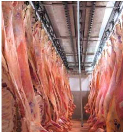
**Примерная продолжительность процесса дефростации: температура внутри камеры 26 °C - 32 °C, влажность 95 %.**
