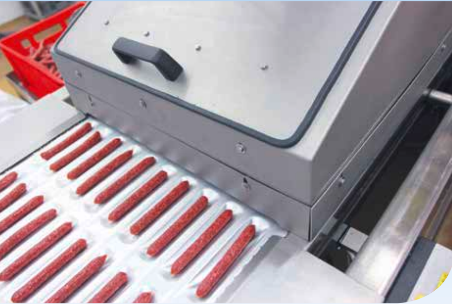
robo Control prüft die Produkte und die Siegelnähte in der Packung robo Control checks products and sealing seams of the packaging
