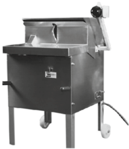
Schlaufenknotmaschine E85-2 zum Aufhängen von Fleischstücken. Mit Rauchstockanlage direkt auf den Rauchspieß aufhängen.
