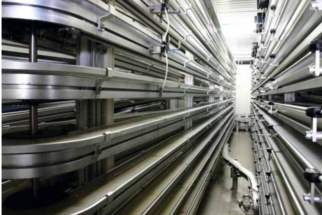
In den Kühltunneln werden die Spezialitäten wie Emmentaler aus Heumilch schnell herabgekühlt. The cooling tunnels ensure that specialties such as Emmentaler are cooled down quickly.
