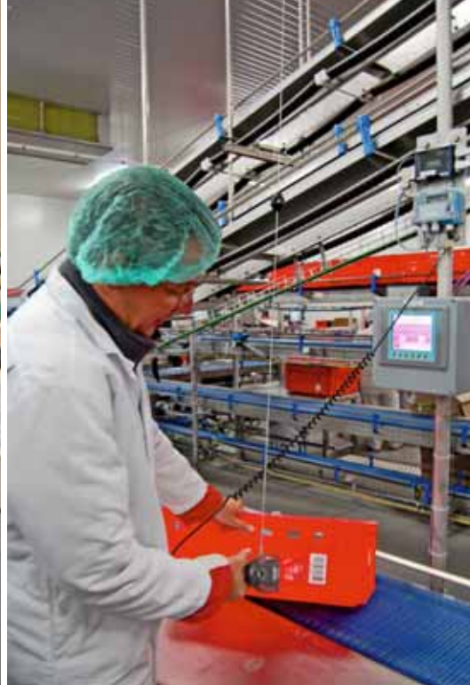
Die Kisten und Kartons werden mit allen relevanten Daten versehen und können während des ganzen Prozesses verfolgt werden. The crates are labelled with all relevant data and can be traced during the whole process.
