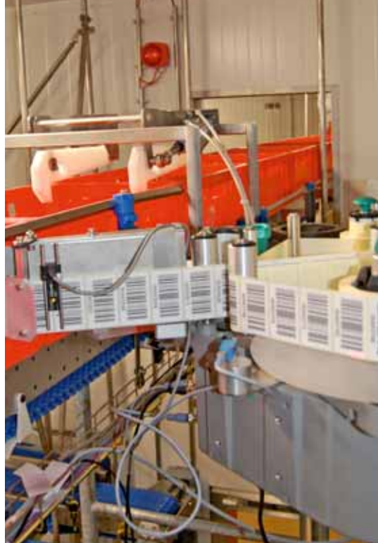
Die Kisten und Kartons werden mit allen relevanten Daten versehen und können während des ganzen Prozesses verfolgt werden. The crates are labelled with all relevant data and can be traced during the whole process.
