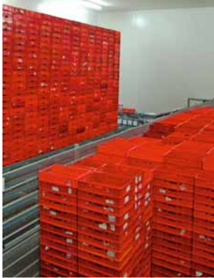
Der Leerkistenpuffer kann bis zu 5.000 Kisten aufnehmen und über die weit verzweigte Fördertechnik bereitstellen./ The buffer store for empty crates has a capacity of 5,000 boxes that can be made available via the conveying system.
