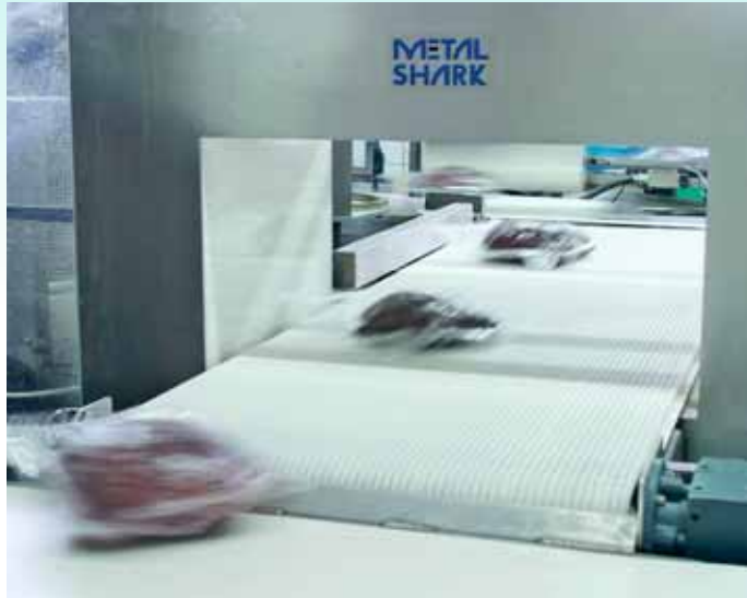
Der Metalldetektor Metal Shark reagiert besonders empfindlich auf Metallverunreinigungen./ The metal detector Metal Shark reacts very sensitively to metal impurities.
