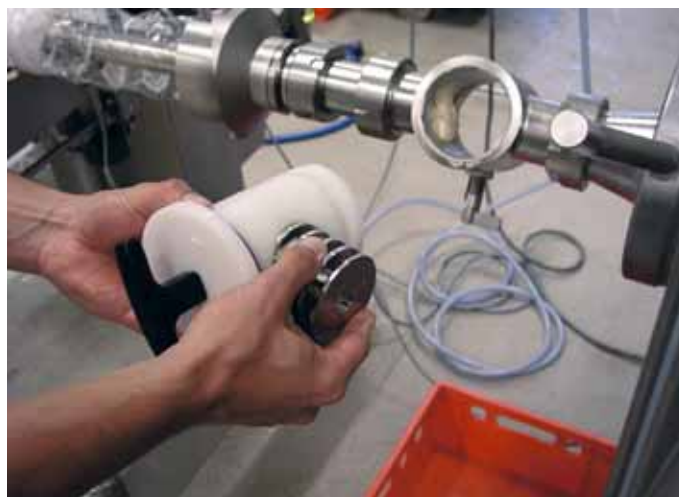
Das Vemag Schnellwechselsystem macht die Handhabung von Fülldüsen einfach/ The Vemag quick-change system makes the operation of filling jets easy
