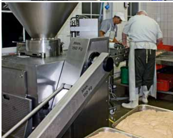
Das Abdrehgetriebe lässt sich mit wenigen Handgriffen austauschen./ The linking gearing can be removed quickly for product changes.
