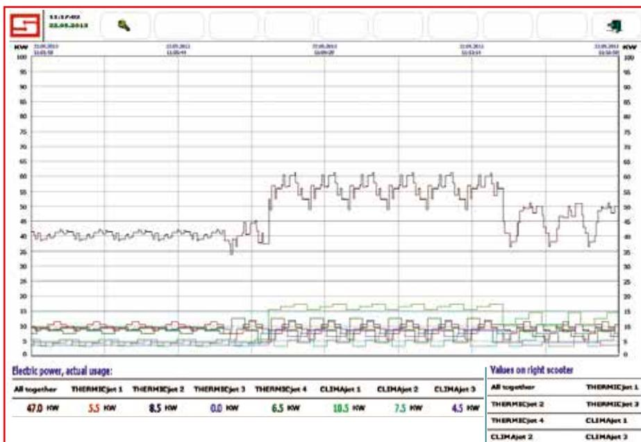
Программное обеспечение визуализации производственного процесса InTouch показывает кривые производительности установок Schröter (в данном примере семь штук). Верхняя коричневая кривая показывает общее потребление всех установок в кВт, нижние фиксируют потребление каждой установки по отдельности.
