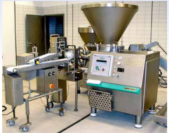
Vemag Koextrusionssystem 891 für Herstellung gefüllter taschenförmiger Produkte/ Vemag coextrusion system 891 for producing filled pocket-shaped products
