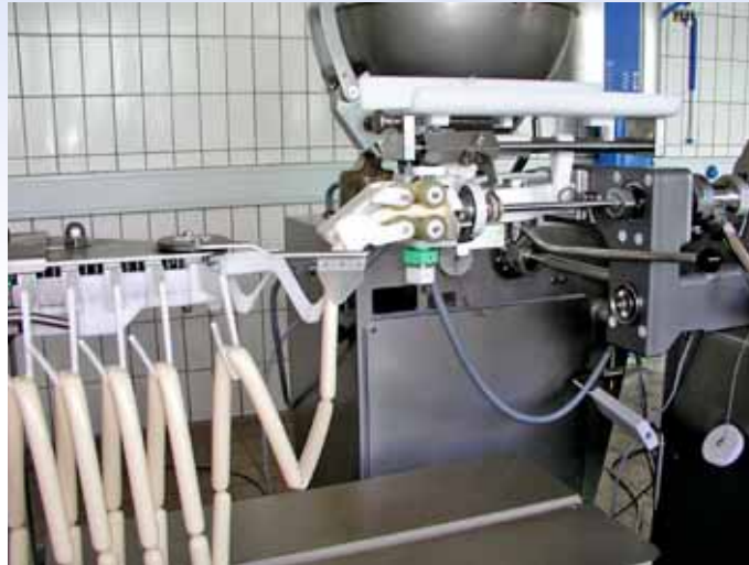
Vemag Koextrusionseinrichtung Typ 892 zur Herstellung gefüllter Würstchen/ Vemag coextrusion system 892 for producing filled sausages
