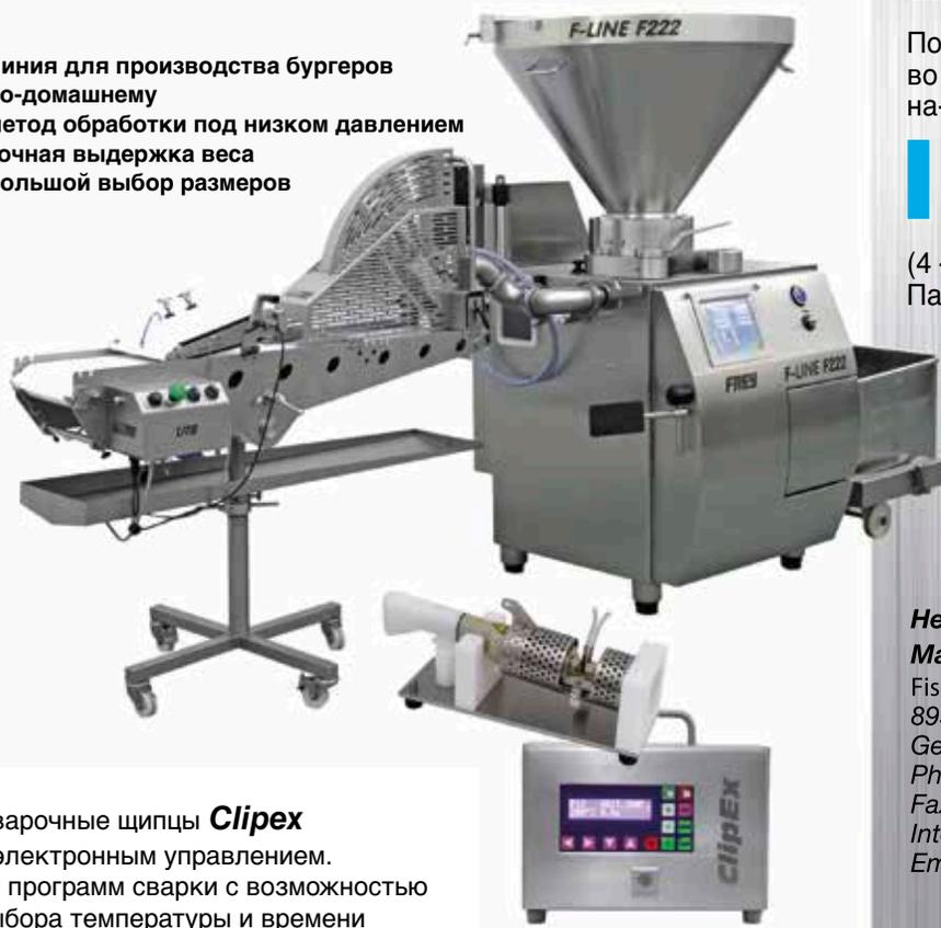
Сварочные щипцы **Clipex** с электронным управлением. 20 программ сварки с возможностью выбора температуры и времени
