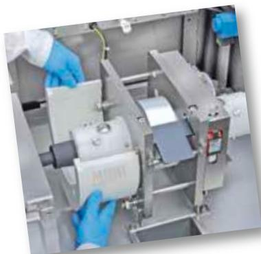
Безупречный в гигиеническом отношении чешуйчатый лед является важной предпосылкой для гигиеничного производства продуктов питания. Поэтому гигиеническое состояние льдогенератора должно регулярно контролироваться и при необходимости должна производиться очистка машины. Все генераторы чешуйчатого льда компани
