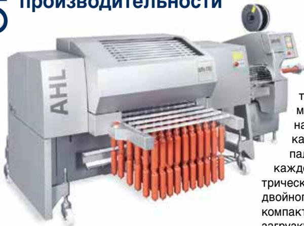
AHL – полностью автоматическая линия для навешивания – обеспечивает точное размещение колбасных батонов на коптильных палках. Оптимизация автоматического процесса уменьшает количество операторов и заметно увеличивает прибыль.
