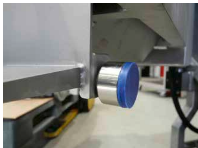
Gut versteckt: der Betätigungsmagnet des Sicherheitssensors im Anschlagpuffer.
