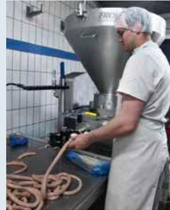
Der Universal-Vakuumfüller F222R von Frey Maschinenbau ist eine unverzichtbare und zuverlässige Maschine, in der viele Wurstsorten, z.B. die Salami, entstehen. Auch der Füllwolf WK 160 (Bilder linke Seite, o.re.) leistet hier wertvolle Dienste.
