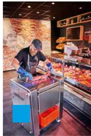
Den neuen Entvliesser gibt es auch in einer Eco-Ausführung, die sich gut für Schwein, Wild und Geflügel eignet. AMS 400 Eco benötigt keine Druckluft, da die Zugwalze der Maschine mechanisch gereinigt wird. So entfällt der Einsatz eines Kompressors was die Betriebskosten senkt und mehr Nachhaltigkeit generiert. Durch den offenen Maschinenständer sowie den Wegfall der Druckluftschläuche punktet der Entvliesser auch in Sachen Hygiene. [www.weberweb.com](http://www.weberweb.com)
