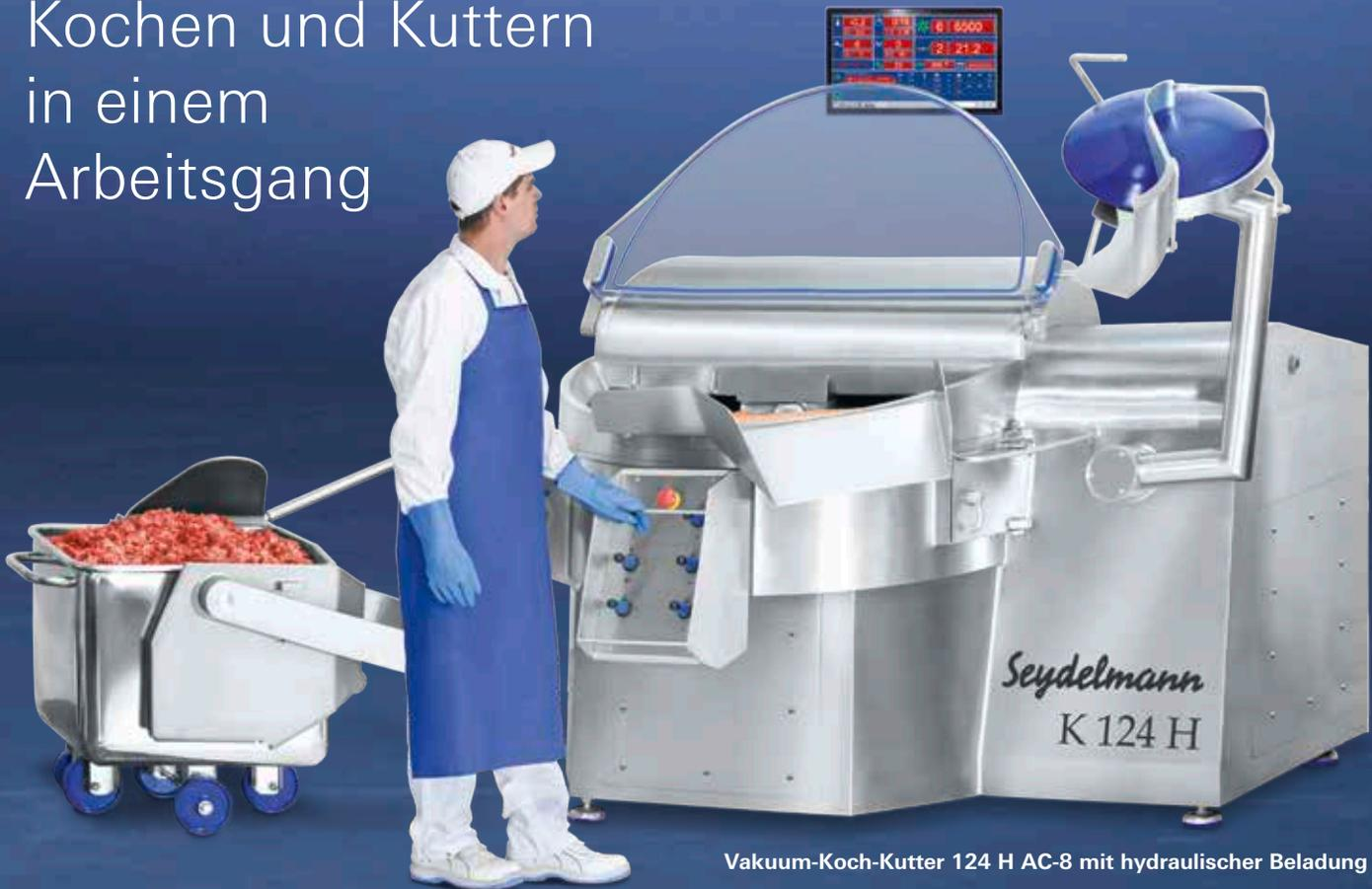
Vakuump-Koch-Kutter 124 H AC-8 mit hydraulischer Beladung
