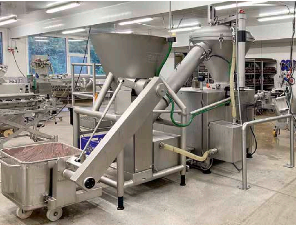
▲ Die Füllmaschine XP1 mit Total-Vakuumsystem wird für die Herstellung von hochwertigen Kochschinken und vielen anderen Wurst- und Fleischprodukten genutzt. / The XP1 filling machine with total vacuum system is used for the production of high-quality cooked ham and many other sausage and meat products.
