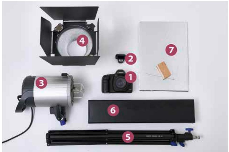
Artikelübersicht: 1. Kamera, 2. Blitzauslöser, 3. Studioblitz, 4. Normalreflektor mit Lichtklappen, 5. Stativ, 6. Abschatter (schwarzer Karton), 7. Reflektoren (Kartons mit silberner Beschichtung)
