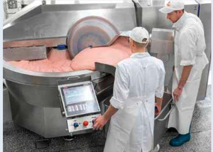
Der VCM 360 „Hygienic Secure“ ist komfortabel zu bedienen und spart Zeit und Energie bei Verarbeitung und Reinigung. Die Konstruktion des Kutters erlaubt eine optimale Ausnutzung des Schüsselvolumens – für große Chargen, ohne Verluste durch Überlaufen.
