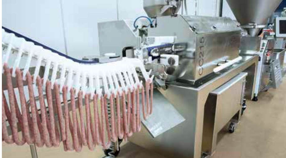
Lösung für die Herstellung vegetarischer und veganer Produkte: das Vorsatzgerät CC215 von Vemag Maschinenbau. / Solution for the production of vegetarian and vegan products: the CC215 attachment from Vemag Maschinenbau.
