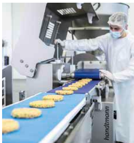
Integrativ: das Form- und Schneidsystem FS 525 von Handtmann. / Integrative: the FS 525 forming and cutting system from Handtmann.
