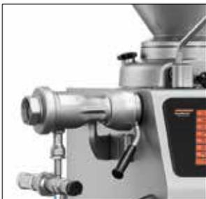
Auslauf des Füllers angeschlossen. Durch separate Antriebe im Füller und im Füllwolf können die Portionier- und die Schneidgeschwindigkeit individuell auf das jeweilige Produkt abgestimmt werden.
