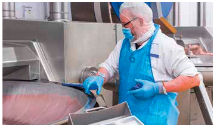
Zum Reinigen lassen sich viele Bauteile der Hygienic-Secure-Kutter mit einem Handgriff entnehmen und wieder einsetzen – für eine schnelle und einwandfreie Hygiene. / Many components of the Hygienic Secure bowl cutter can be removed for cleaning and reinserted in no time – for fast and perfect hygiene.
