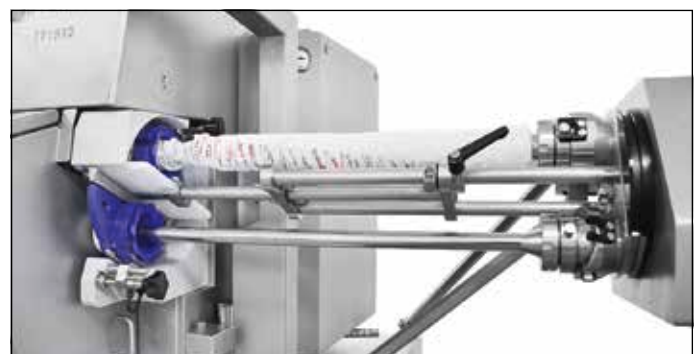
Parallelrevolver für kürzere Umrüstzeiten.
