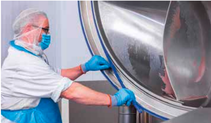
Klaus Haskamp entnimmt den Messerdeckelstreifen; die Dichtungsnut kann rückstandsfrei gereinigt werden. / Klaus Haskamp removes the knife cover strip and the sealing groove can be cleaned without leaving any residue.
